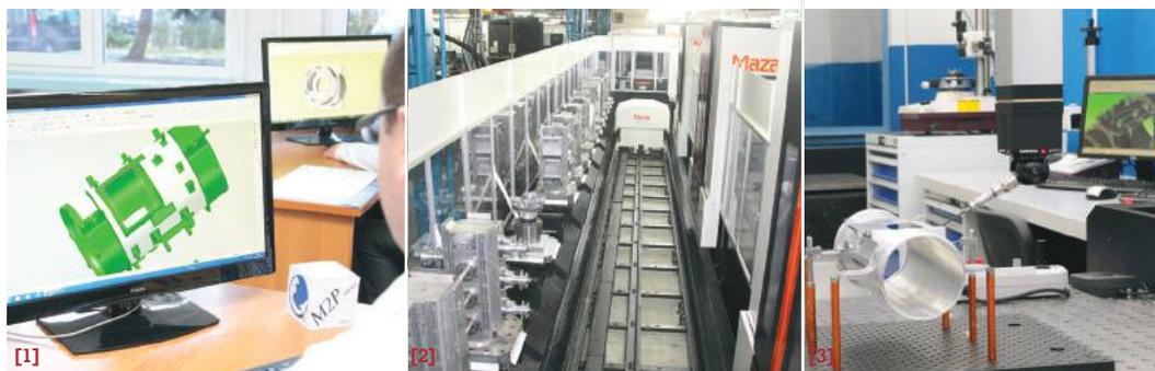
[1] Bureau des méthodes, programmation. [2] Ligne flexible d'usinage. [3] Contrôle tridimensionnel.
